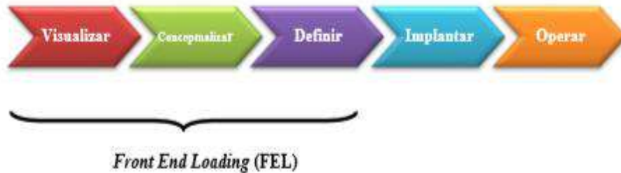
Infograma 2.2. Fases de la planificación de un proyecto Fuente: Adaptado de CII (2017)
