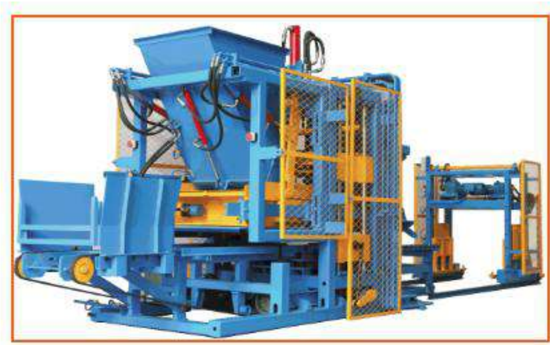
Figura 14. Estación de vibrocompactado. Fuente: (www.reit.com.cn, 2017)
