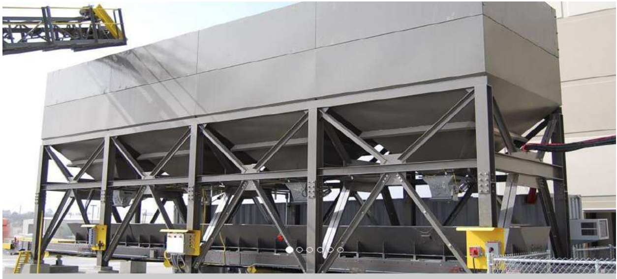
Figura 11. Tolvas de almacenaje de agregados. Fuente: ( www.columbiamachine.com , 2017)
