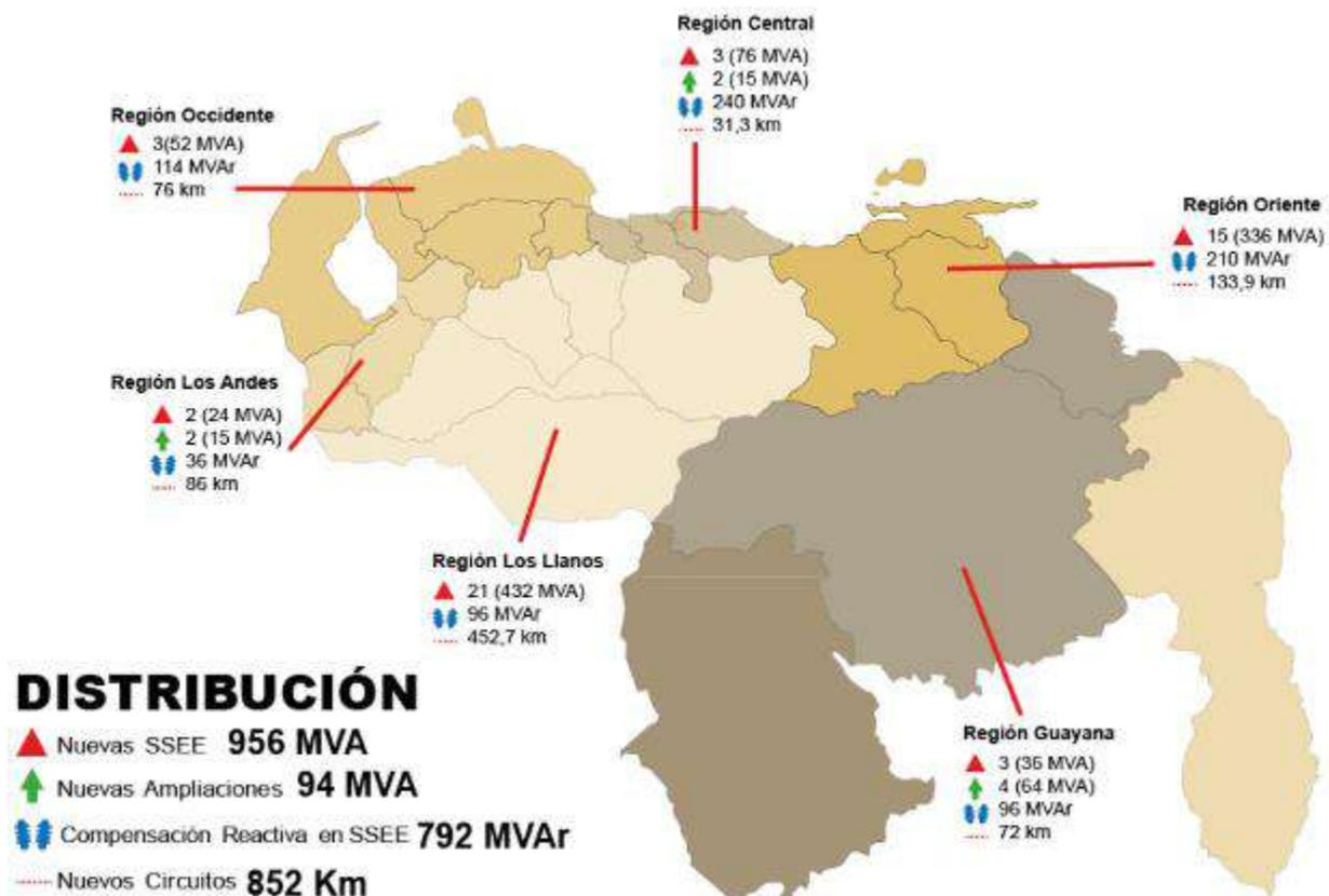
Figura 3.11. Distribución de Energía Eléctrica
