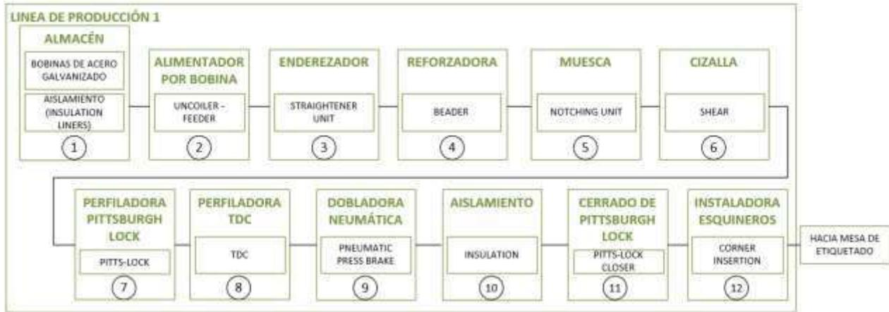
**Figura 50 . Estaciones de trabajo para Ductos Rectos. – Línea de producción 1.**
