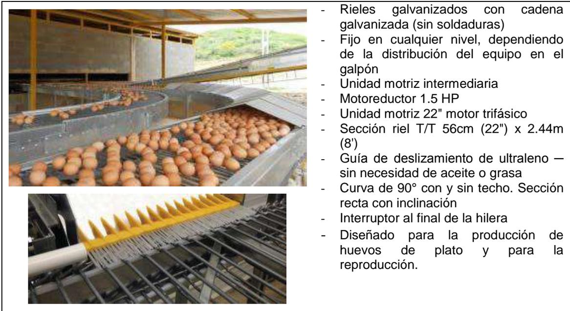
**Figura 21. Transportador Transversal de Huevos (Adicional – conexión a transportador principal)**
