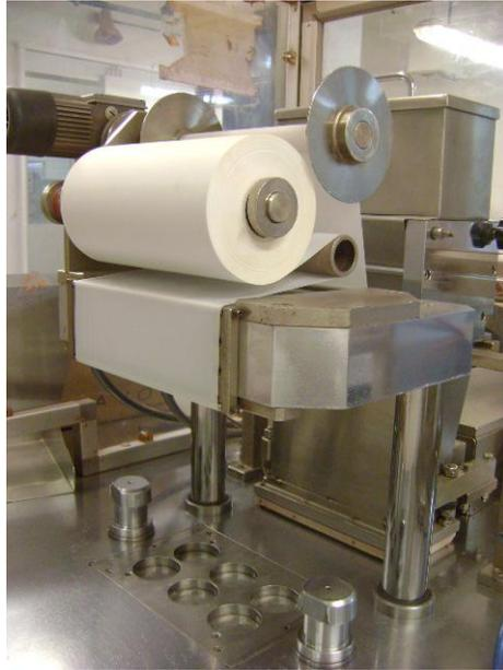
**Ilustración 3. Bobina de Tafetán en montaje lista para ser usada.**
