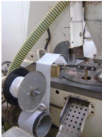
**Ilustración 6. Vista trasera del equipo. Tafetán usado en la operación de Prensado.**
