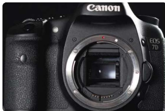
Sensor de la cámara. Fotografía realizada para el manual
