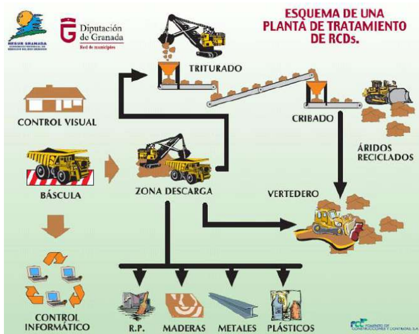
Figura 7. Esquema de producción de planta de tratamiento de RCD.
