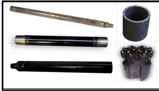
Figura 8. Barra de perforación. Corona. Camisa de Revestimiento. Martillo de Fondo. Roseta de perforación. Fuente: www.cgr.it
