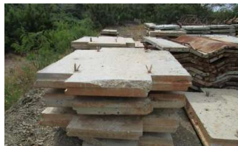
Figura 33: Escamas con daños en bordes y coloración Fuente: Archivos Tierra Armada
