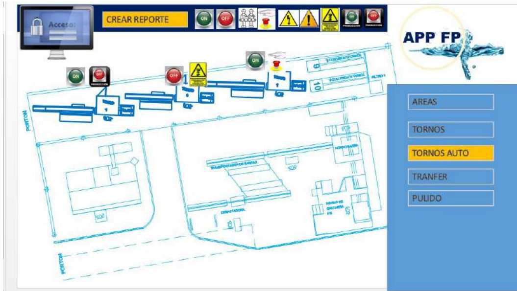
Figura VI-7. Visualización de esquema en área de tornos con cargador
