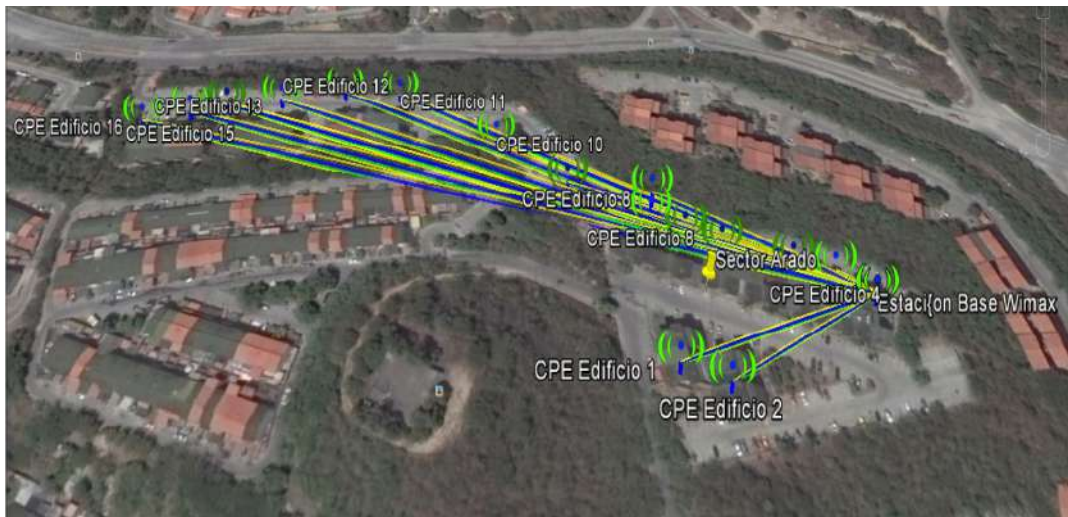
Figura 8 Distribución de la señal Desde El Edificio 3 Hacia los Edificios 1, 2, 3, ... 16 Del Sector El Arado
