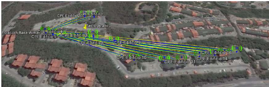
Figura 10 Distribución de la señal de la Estación Base a los 15 Edificios Del Sector Arado Fuente: Adaptado de Radio Mobile (2019)
