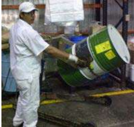
Ilustración 12. Pesaje del aceite mineral con el volteador de tambores
