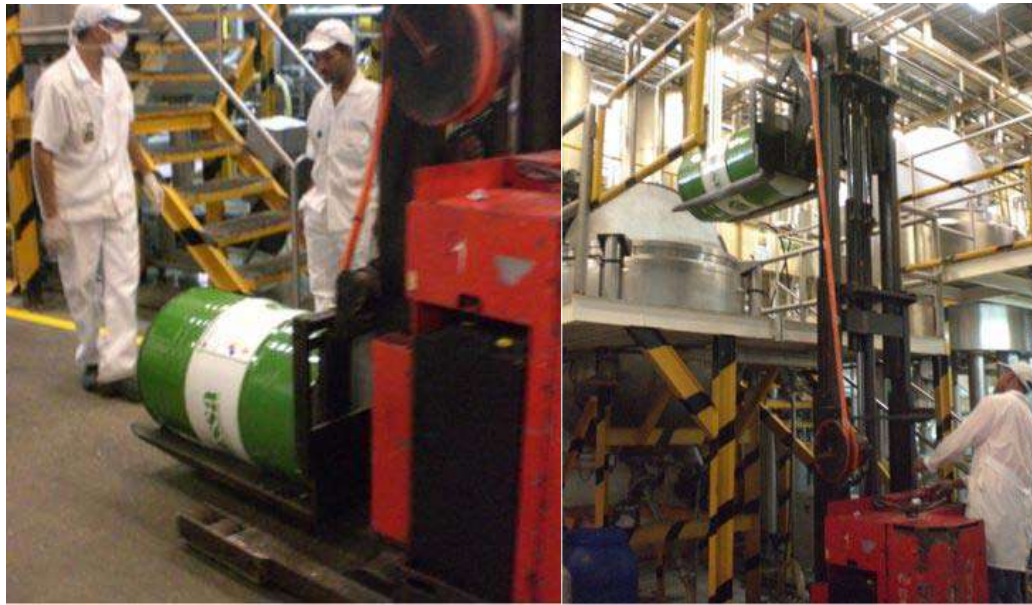
Ilustración 11. Manejo de aceite mineral con el montacargas
